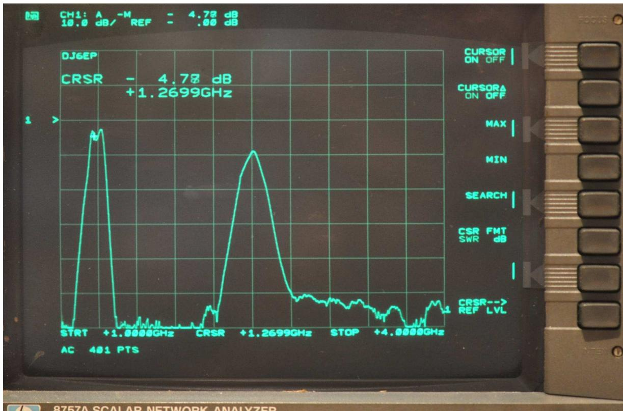
Tak wygląda w praktyce wzmocnienie toru nadawczego w funkcji częstotliwości między 1000 a 4000 MHz. Jak widać wzmocnienie dla częstotliwości harmonicznych wychodzących z mieszacza jest tak potężne, że pasmo wyjściowe nadajnika może być tylko "zbiorem smieci".
